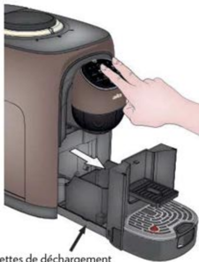
Cuvettes de déchargement
